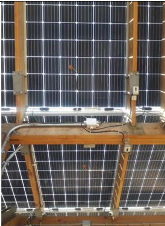
Figura 21 - 2 Sensores de temperatura en módulos PV bifaciales
