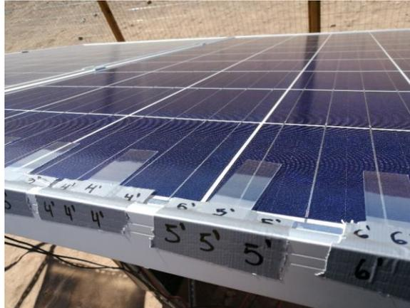
Figura 1: Imagen del montaje de portamuestras en un sistema fotovoltaico en condiciones desérticas
