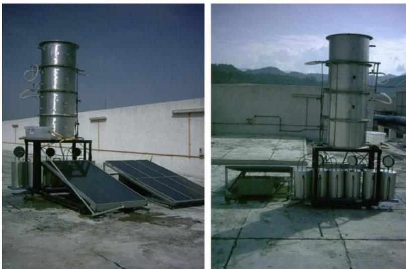
Figura 6: Sistema de destilación solar evacuado de varias etapas
